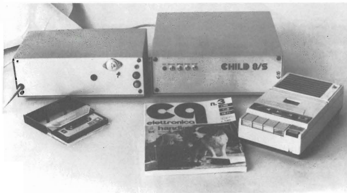
Tanta memoria a buon mercato tramite l'uso dello SCA (Standard Cassette Adapter): un qualunque registratore può essere usato senza modifiche per memorizzare programmi e dati. La descrizione dello SCA verrà presto pubblicata su cq elettronica.
